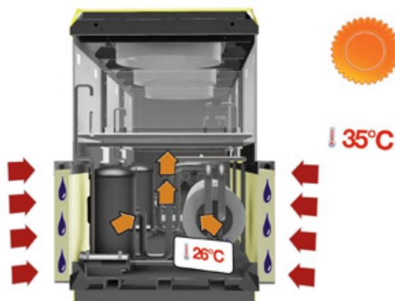
**СТАНДАРТНЫЕ И АДИАБАТИЧЕСКИЕ ЧИЛЛЕРЫ СО ВСТРОЕННОЙ СЕКЦИЕЙ FREE-COOLING**
